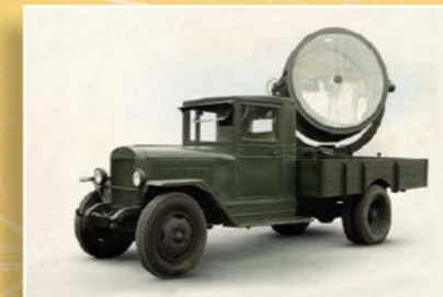
Зенитная прожекторная станция 3-15-4 на базе автомобиля «ЗИС-5»
