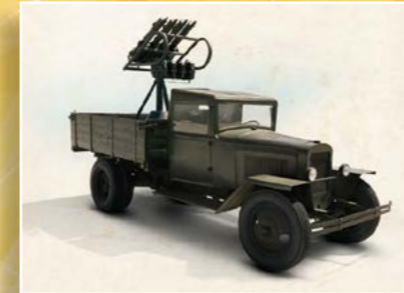
7,62-мм счетверенная зенитная пулеметная установка на базе автомобиля «ГАЗ-АА»
